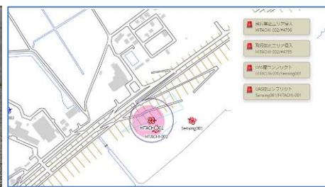
機体障害検出時に、機体の周囲に飛行禁止エリアを生成、警告を発している。
