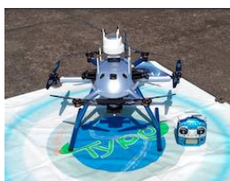
気象観測ドローン ACSL-PF2(R-SWM)
